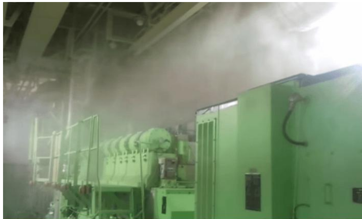
Slika 4: Gašenje z vodno meglo (vir Marine Insight)
