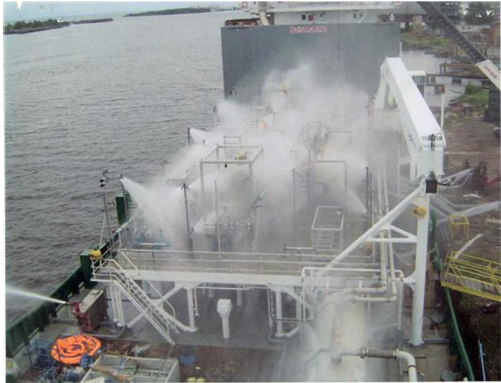
Slika 3: »Drenčer« sistem gašenja na palubi (vir EFS)
