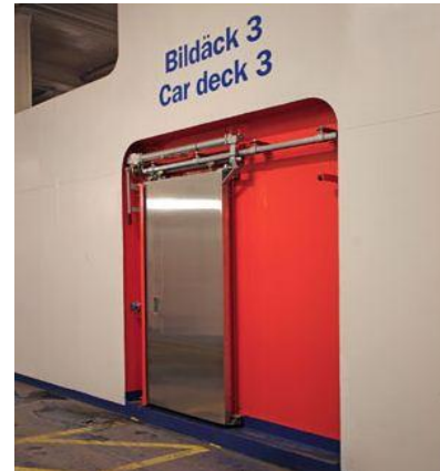
Slika 5: Požarna vrata na RO-RO ladji (vir Equip4ship)
