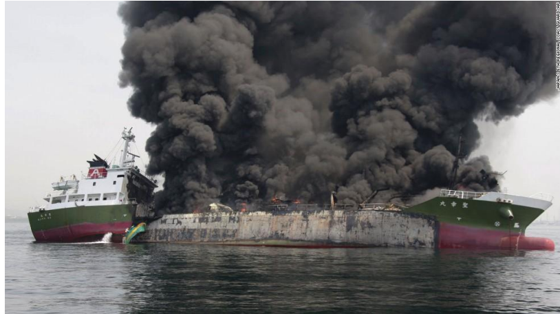
Slika 7: Potopitev ladje kot posledica požara – popustitev »opločja« in vdor vode (vir CNN)
